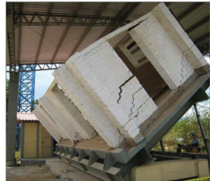
Figure 4. Hydraulic lateral tilting table test machine. Photo: Universidad de El Salvador
